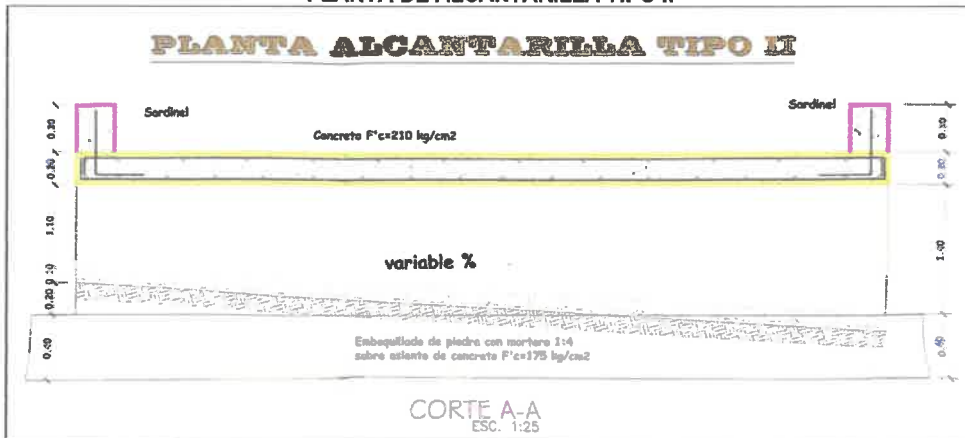
IMAGEN N° 3 PLANTA DE ALCANTARILLA TIPO II
