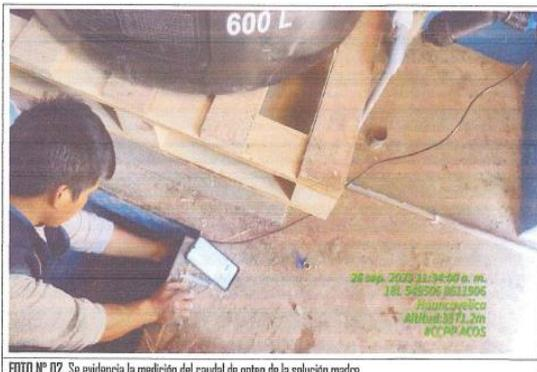
FOTO N° 02. Se evidencia la medición del caudal de goteo de la solución madre.
