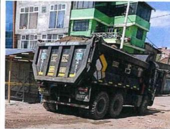
**Descripción:** Se constata volquetes saliendo de las instalaciones de la obra, trasladando la eliminación de material proveniente de la demolición y excavaciones, cubierto parcialmente con malla en la tolva de los volquetes y sin sujeción. La especialista en SOMA, indica que están trasladando al botadero de la Municipalidad del Distrito de Chilca.
